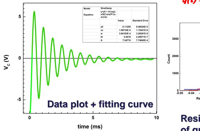
$q(t) = Ae^{-at}sin(\omega t + \varphi)$
